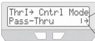
Mode de contrôle accélérateur par défaut : Pass-Thru. Utiles aussi : modes Courant et Puissance
